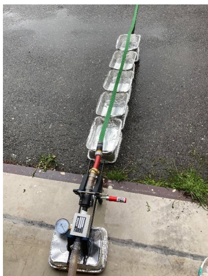
Figur 21: Oppsett for måling av vannføring og trykk for sprederslangen, Ås, 14. juli 2020
