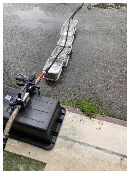
Figur 22: Oppsett for måling av vannføring og trykk for svetteslangen, Ås, 14. juli 2020
