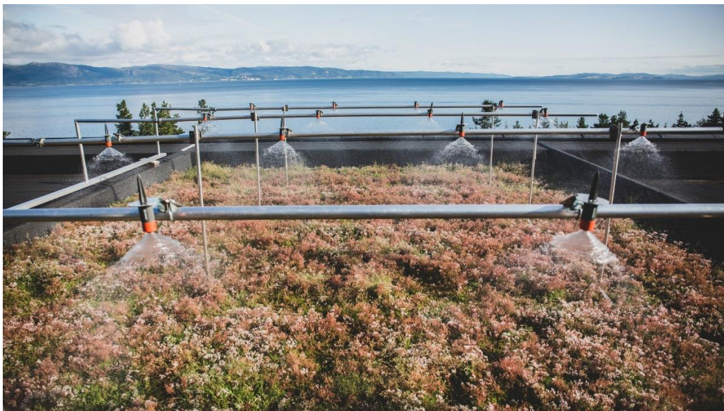
Figur 13: Nedbørssimulerende vanningsanlegg på Høvringen (Øfsti & Solbu, 2019)
