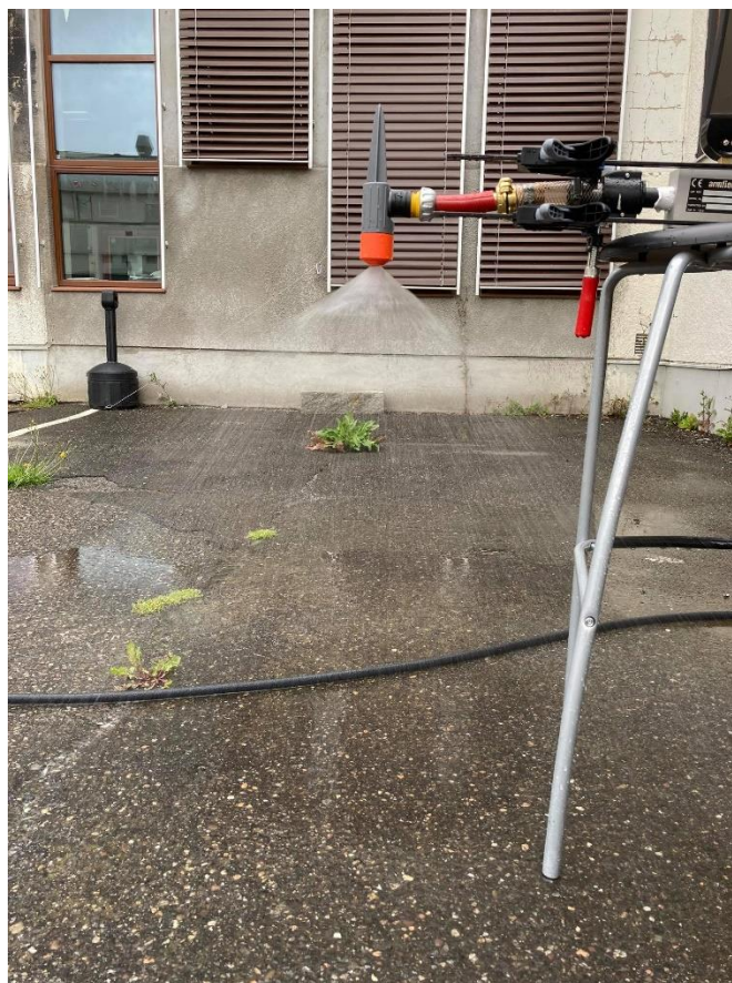
Figur 25: Oppsett for måling av vannføring og trykk for sprederen, Ås, 14.juli 2020
