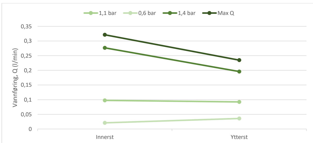
Figur 27: Differanse i vannføring mellom innerst og ytterst på slangen (test nr. 2-5)
