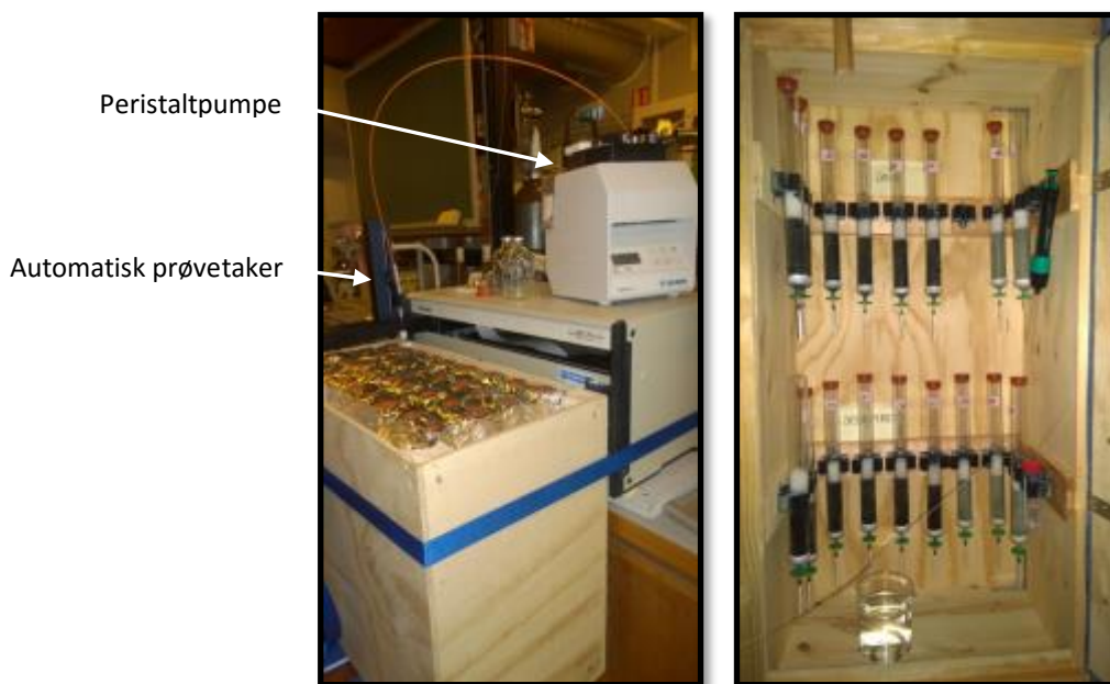
Figur 3. Til venstre: oppsettet som ble benyttet ved måling av gass. Søylen ble oppbevart i en trekasse og dekket til for å hindre lystilgang. På bildet vises også peristaltpumpen og den automatiserte prøvetakeren. Til høyre: skapet som ble benyttet til oppbevaring av søylene ved påfylling/drenering og i perioder uten gassmåling.
