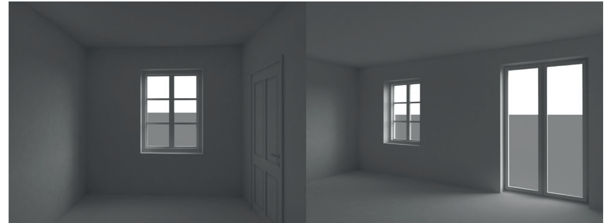
Fig 5.3. Bildet til venstre viser det opprinnelige rommet med verst dagslysfaktor i første etasje, hvor møterommet nå er plassert. I bildet til høyre er veggen fjernet og det er satt inn nytt vindu hvor døren tidligere var. Dagslysfaktoren i rommet er økt fra 1,0 % til 2,2 %.
