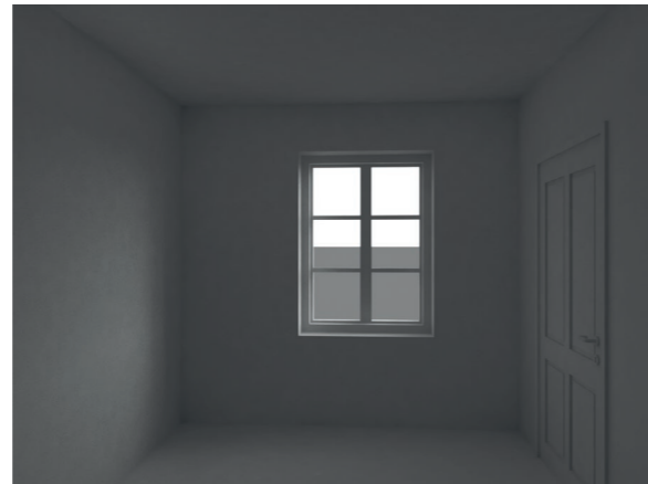
Fig 3.18. Visuell fremstilling av norvestvendt rom med verst dagslysfaktor i første etasje (1,0 %).
