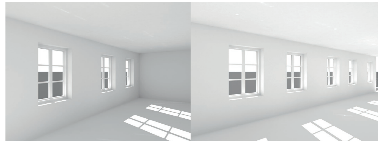
Fig 5.4. Bildene viser en sammenlikning av kaféområdet i første etasje, hvor innsetting av glassbyggene og fjerning av vegger har økt dagslysfaktoren fra 1,5 % til 2 %.
