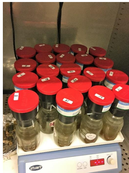
Figur 7: Inkubering av 21 ferdigstilte prøver med gassmålingsmoduler på vippebrett. Foto: Thea Brustad
