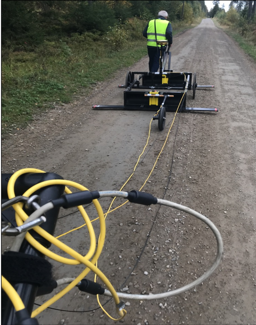
Figur 3.6 Opptak med georadar der SmartCart oppsettet har to meter mellom 50 MHz antenner.
