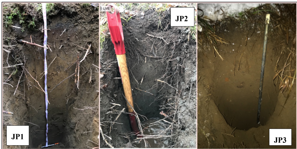
Figur 3.2 Jordprofiler til ca. 0,8-1 meter dybde for hver lokalitet der jordprøvene ble tatt ut. (Foto: Stine Maleen T Hagen)
