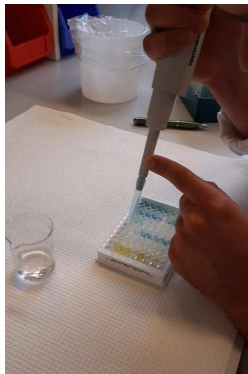
Figur 9 Stopreagens blir tilsett brønnane slik at dei blå blir gule. Omslag frå blankt til blått betyr binding mellom antistoff og antigen
