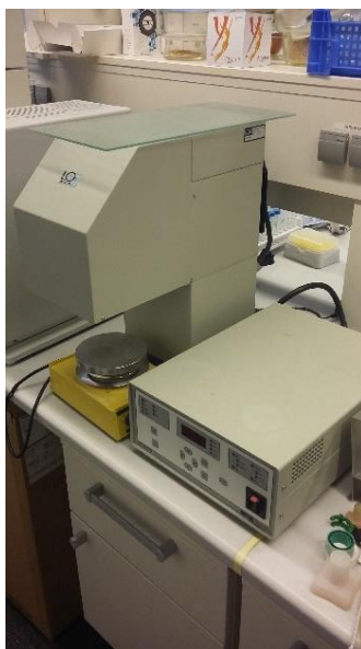
Fig. 28 300 W sollyssimulator med en Xenon-lampe og en magnetisk rører (LOT Oriel Instruments, Darmstadt, Tyskland)
