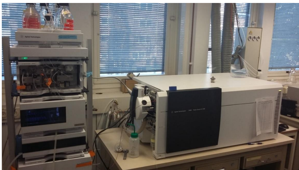
Fig. 29 HPLC-system koblet til en MS/MS trippelkvadrupol med en elektrosparyonekilde (ESI-ionekilde) (Adamstuen, Oslo, Norge)
