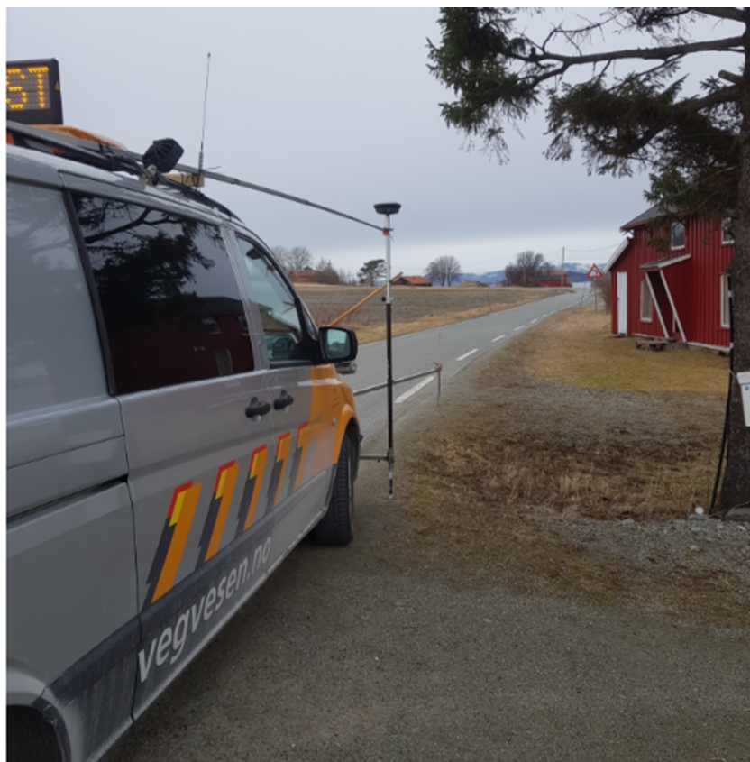
Figur 5.1: Bilde av kjøretøy fra målingene mars 2020. Her var det montert en siktepinne i front av bilen samt et kamera som overvåket siktepinnen. Ved å se på en monitor i kupeen i bilen ble det lettere å sikte etter kantlinjen (Foto:Trond Arve Haakonsen).
