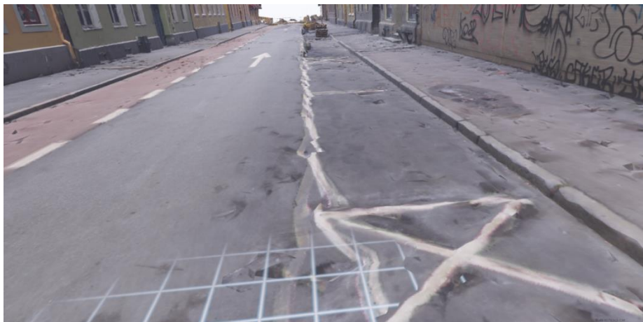
Figur 29: 3D-modell laget i Reality Capture med bildesettene 18.02 og 25.02. Bildet illustrerer ujevnheter i veien der det har stått en bil i det ene datasettet, men ikke i det andre.
