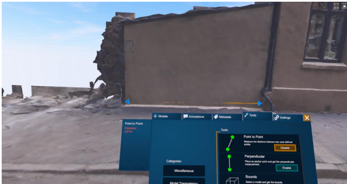
Figur 41: Kontrollering av skalering, ved å måle skuret i Dimension10.
