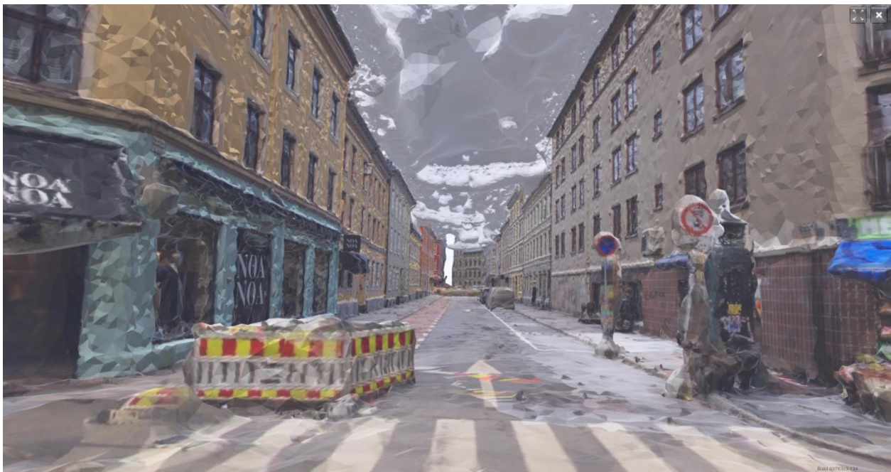
Figur 33: 3D-modell laget i Pix4D med datasettene 18.02 og 25.02. Bildet illustrerer oppblåste veiskilt og skyer som dannes rundt strømlinjer.
