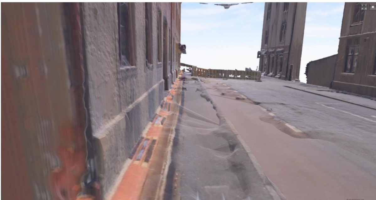
Figur 18: 3D-modell laget i Agisoft Metashape med datasettet 18.02. Bildet viser at programmet har vanskeligheter med å lage jevn bakke, og tekstur på husvegg.
