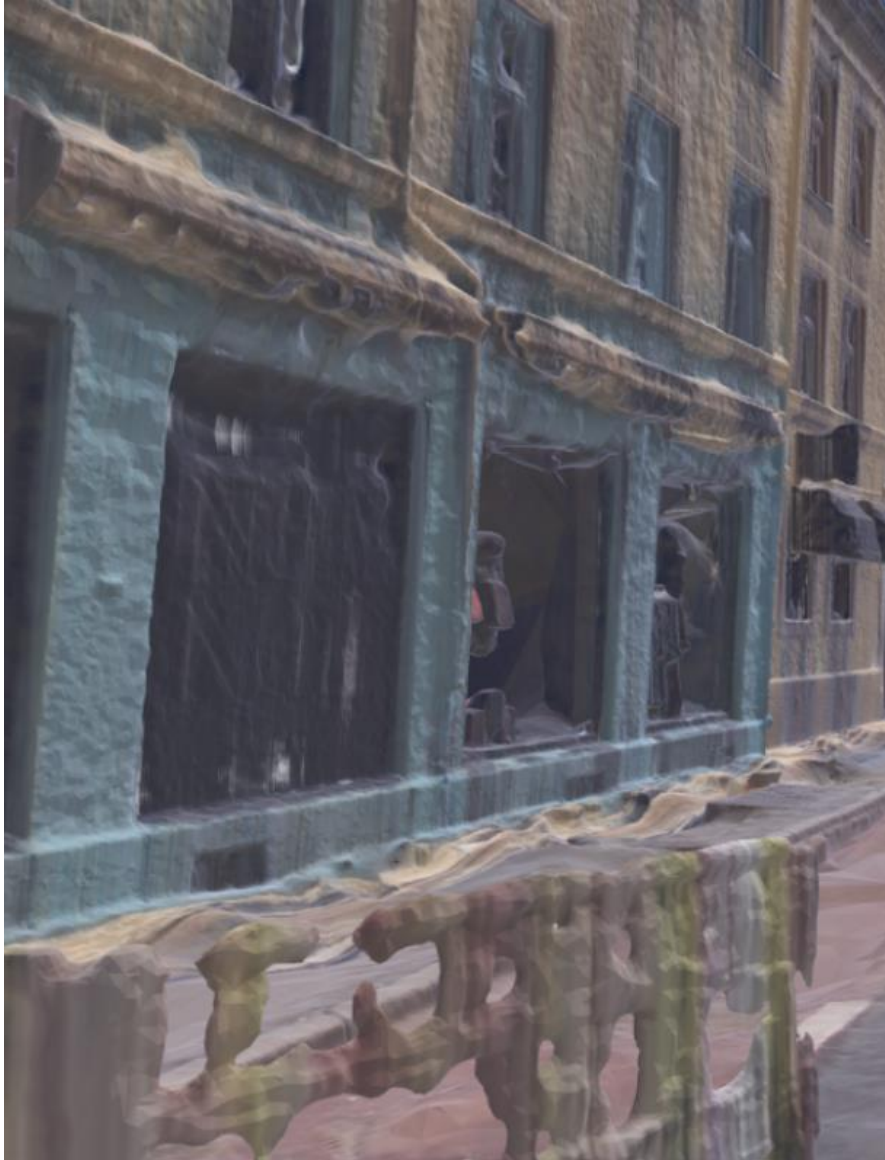
Figur 17: Illustrasjon av 3D-modell med lav kvalitet på geometrisk samsvar. Modellen er laget i Metashape med datasettet 18.02.
