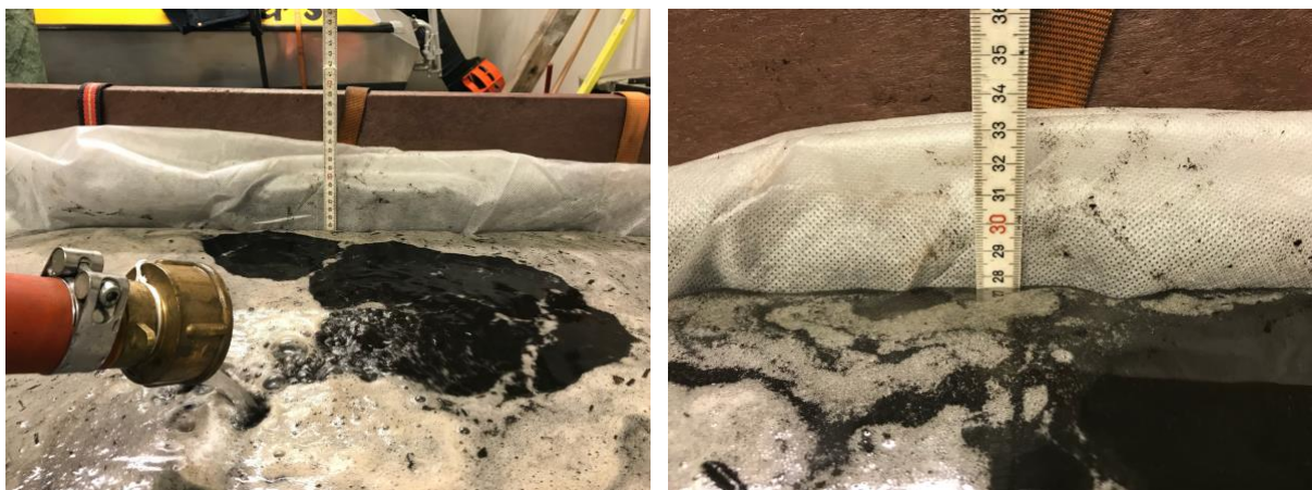
Figur 2.12: Blomsterkassen blir fylt med vann over et jordlag på 18,5 cm. En fiberduk er pakket rundt kassen for å forhindre at jord transporteres videre til fordrøyningskamrene. Foto: Johanne Grøndahl Klausen.
