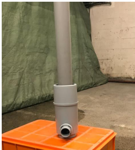
Figur 2.14: Foto fra forsøk med vannføringssplitter tilkoblet taknedløp. Foto: Johanne Grøndahl Klausen.
