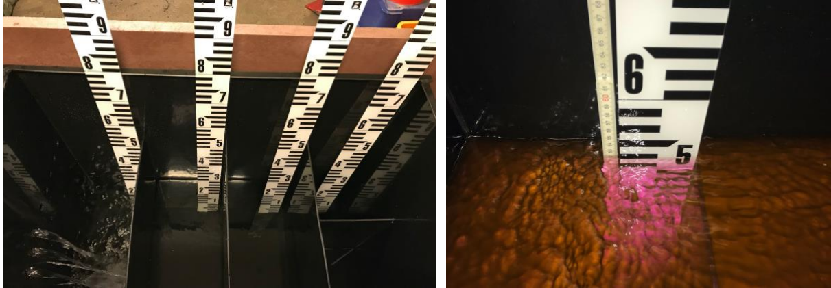
Figur 2.7: Bildet til venstre viser utstyrsoppsett i fordrøyningskamre. Høyre side viser meterstokk med høyere oppløsning og bruk av fargestoff i vannet. Foto: Johanne Grøndahl Klausen.
