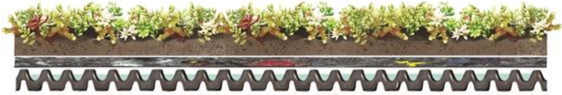
Figur 1.3: Illustrasjon som viser lagvis oppbygning av et grønt tak (Bergknapp, 2020).
