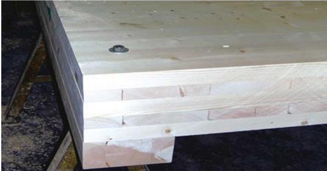
Figur 5: Krysslimt element. Bildet viser hvordan trevirke er limt vinkelrett på hverandre. Foto: SINTEF Byggforsk (SINTEF Byggforsk, 2009).
