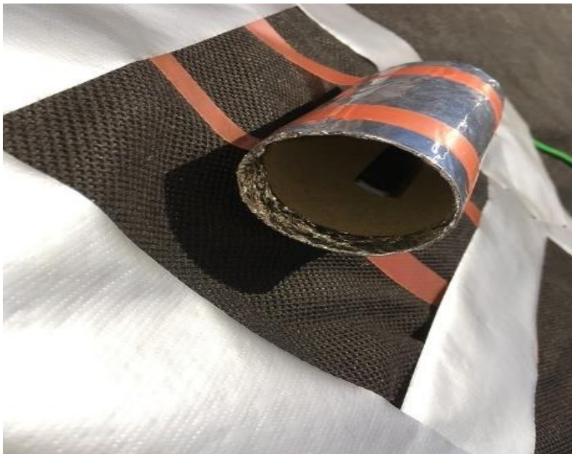
Figur 12: Bildet viser utvendig skjerming av termometeret. Disse skjermingene er identiske både for nord- og sørfasaden (Jørgen Grue).
