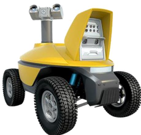
Figur 4.6: SMP Robotics' S3, termisk inspeksjon av transformatorstasjoner og strømnett [32].
