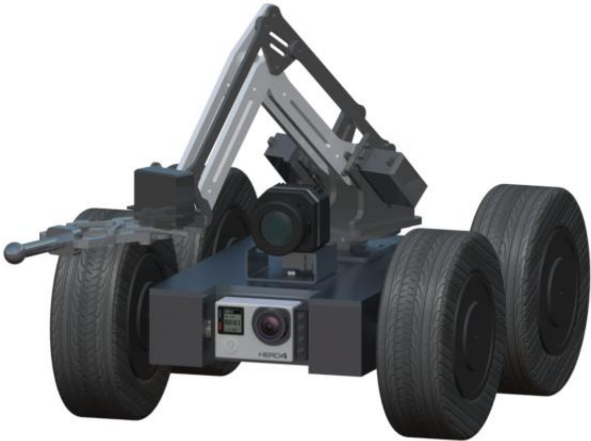
Figur 8.2: Konseptuell 3D CAD modell av inspeksjonsroboten, utstyrt med et frontkamera, et IR-kamera og en robotarm med pinless fuktighetsmåler. GoPro Hero4 [84], Robotarm [85], IR-kamera [86]
