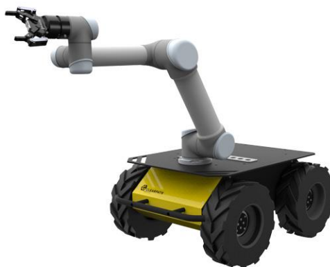
Figur 4.2: Den mobile roboten Husky UGV er utstyrt med en robotarm. Armen gir roboten utvidede bruksområder [25].
