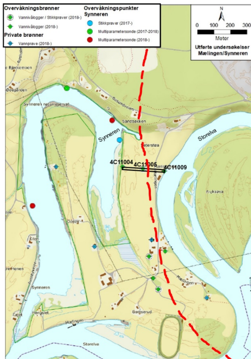
Figur 3.9: De elektriske poretrykksmålerene 4C11004, 4C11005 og 4C11009 på Mælingen hvor den sorte firkanten viser området for grunnvannsmodellen. Rød stiplet linje viser den planlagt traséen. Modifisert fra Norconsult et al. (2019c).
