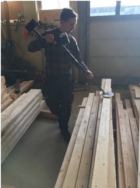
Figur 3-8: Metallsøking i returvirke før høvling.
