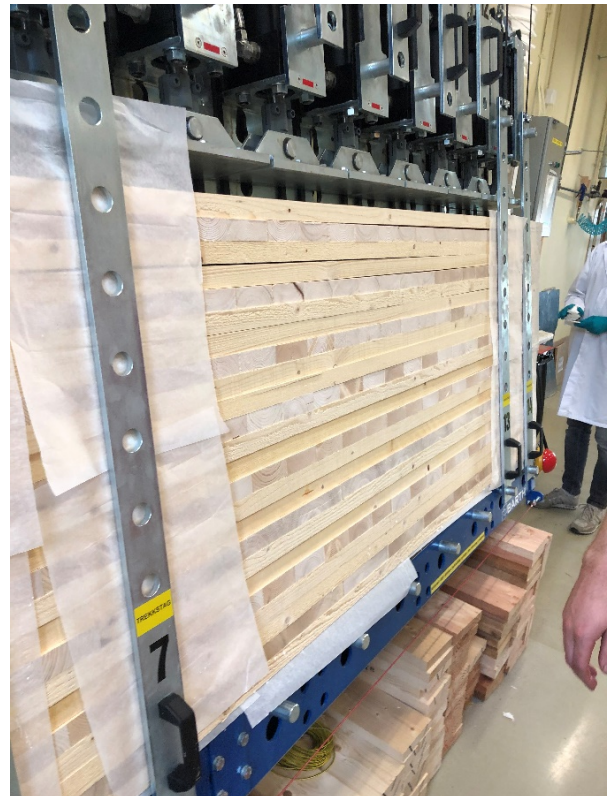
Figur 3-16: 8 testelementer lagt i pressen.
