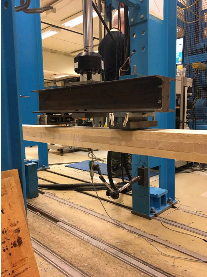
Figur 3-18: Nedbøyningstest. Deformasjonsmåler er montert under prøven for global E-modul beregning.
