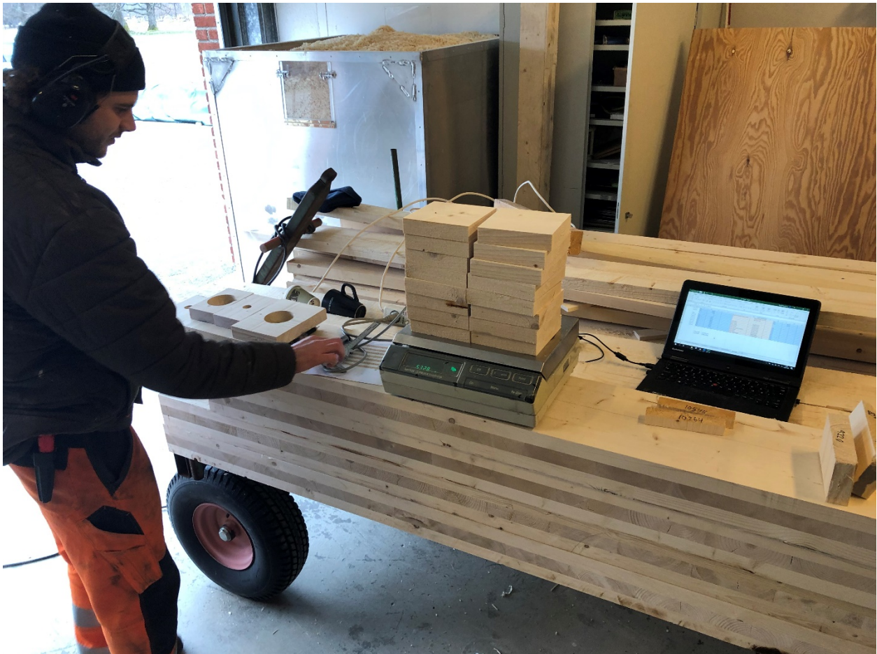
Figur 3-12: Vekt og volum ble målt for alle deler av KL-tre-elementene.
