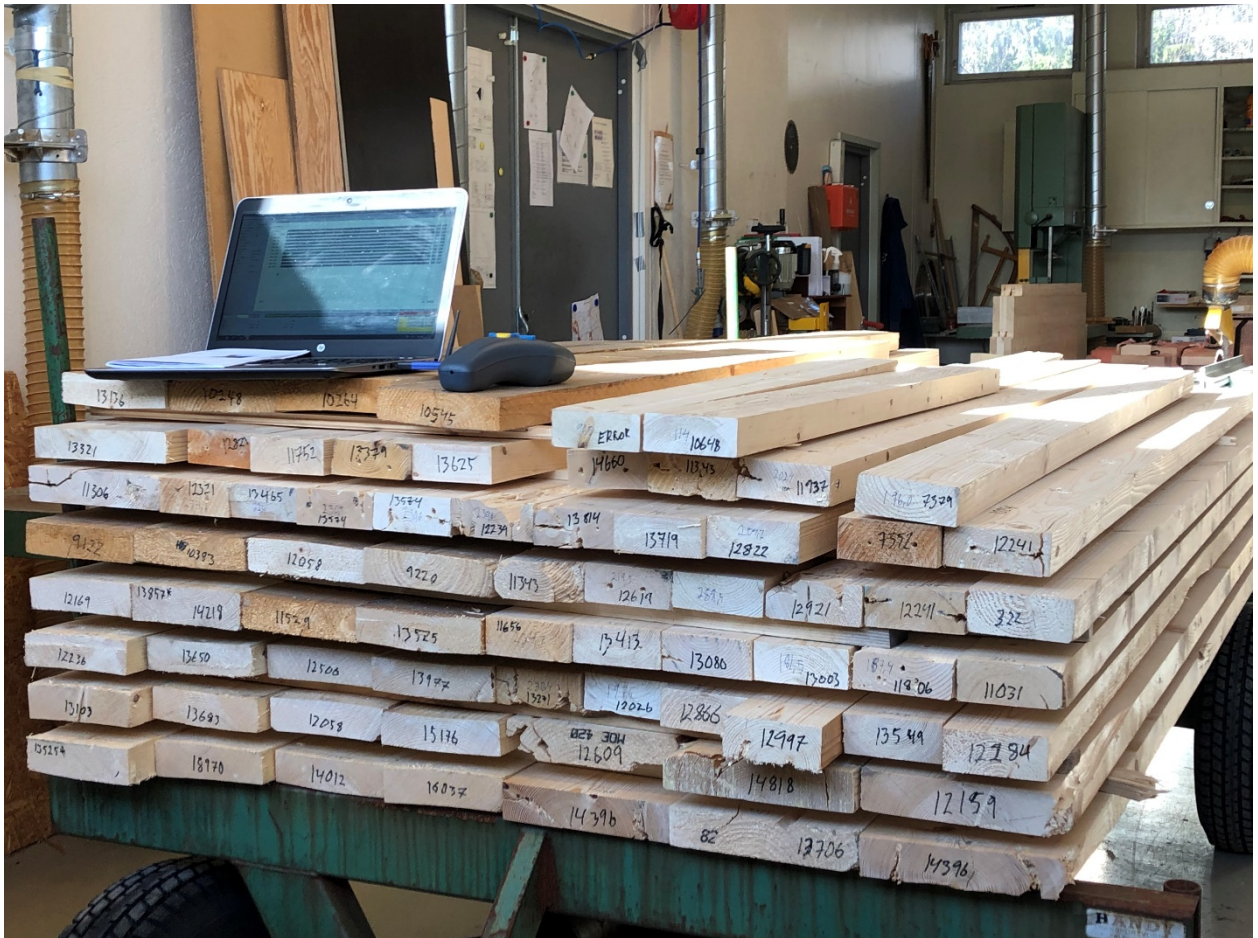
Figur 3-7: Stabel med styrkesortert returvirke, E-modul målt med Brookhois markert i endevenden.
