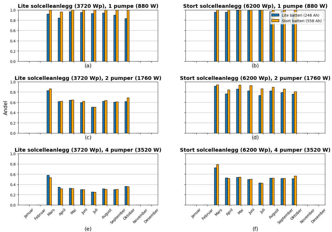
Figur 4.10: Plot over solfraksjonen for de ulike simuleringene med endring i batterisystemets lagringskapasitet. Solcelleanlegget og lasten er uendret innad i hvert plot.
