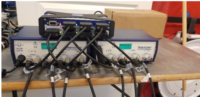
Figur 23: Oppkobling av sensorer til forsterkere og måleinstrumentet QuantumX MX840B (Privat).
