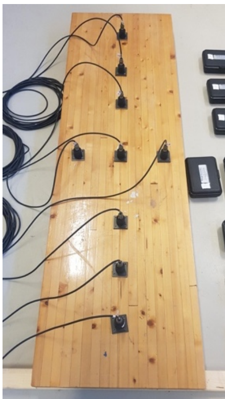
Figur 22: Testoppsett av sensorer på et kantstilt massivtredekke (Privat).
