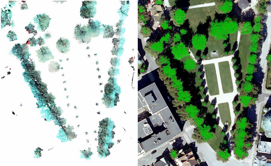
Figur 28: Til venstre er trekrone klippet ut fra CIR-bildet slik at man kan se hva som er under trekrone. Til høyre er et utklipp av resultatet med NDVI-grensa på -0,05 . Det grønne er det som blir definert som gress med ortofotoet fra sommeren i bakgrunnen.
