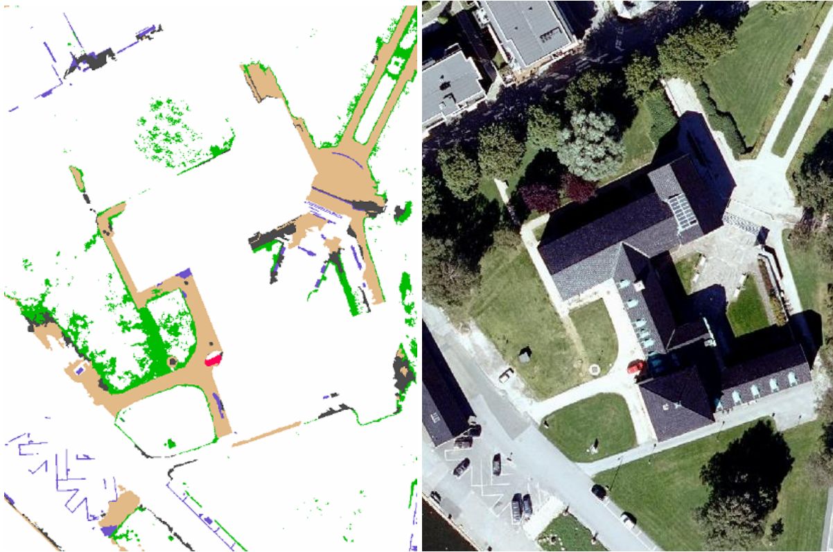
Figur 26: Utklipp av klassifiseringsresultatet til venstre. Ortofoto over samme område til høyre. Det er vegoppmerking nederst til venstre, grus i oppkjørselen til huset og det gresset med lav NDVI har nå blitt klassifisert rett.
