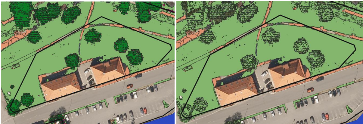
Figur 59: Til venstre er resultatet med tilleggsfaktorer og til høyre er det kun dekktyper. Litt av området under treet som henger over asfalten er riktig definert som asfalt.
