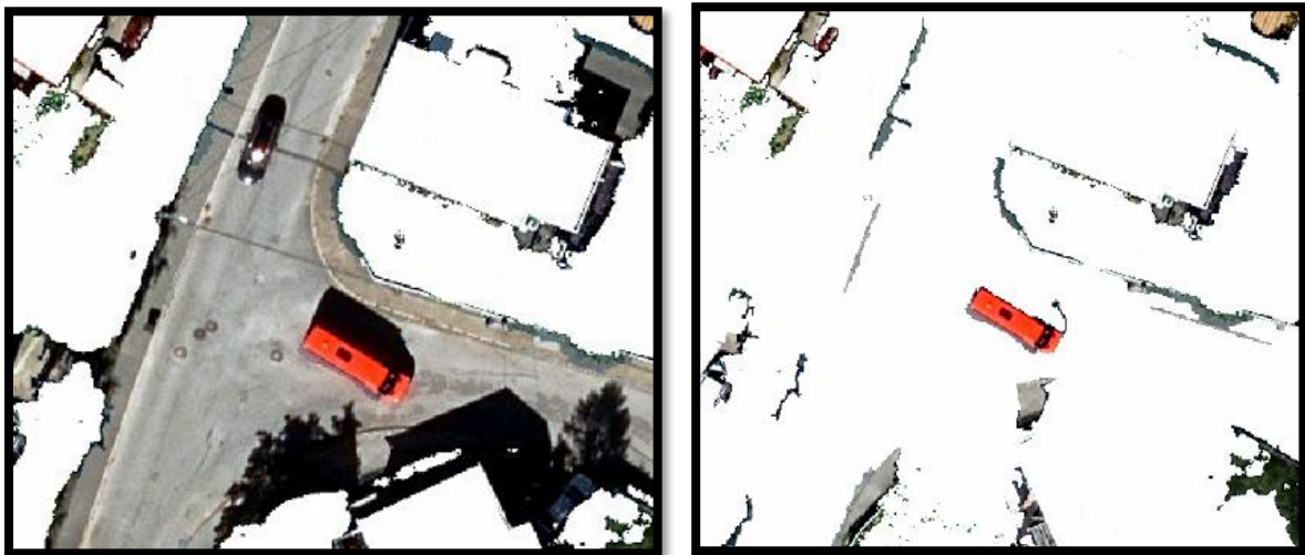
Figur 24: Til venstre: et utklipp av utgangspunktdataen. Til høyre: samme utklipp av det som ble klassifisert som grus. Her kan man se at både en rød bil og litt vegetasjon i høyre hjørne er med.
