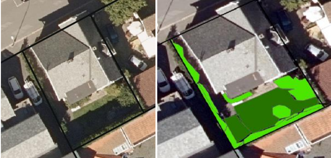
Figur 60: Til venstre er ortofoto og til høyre er tidligere validering av tomt 63 der grønt er gress, lysegrønt er busker og grått er grus.
