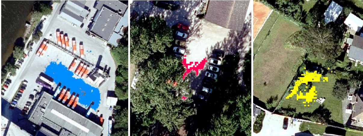
Figur 32: Terrengeforsenkning med fordrøyning som hovedfunksjon til venstre og med infiltrasjon som hovedfunksjon i midten og til høyre. Til venstre er den på en parkeringsplass av asfalt, i midten på en grusparkeringsplass og til høyre på gress.
