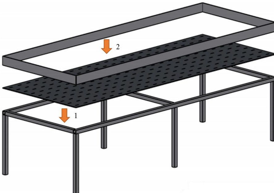
Figur 11.9: Hvordan tørkebordet er sammenstilt. Først (1) er perforert plate sveist på rammekonstruksjonen, rundt hele. Videre (2) er karmen sveist ned i den perforerte platen.
