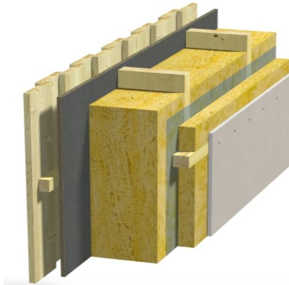
Figur 31. Illustrasjon, snitt yttervegg (GLAVA isolasjon [u.å.]a).
