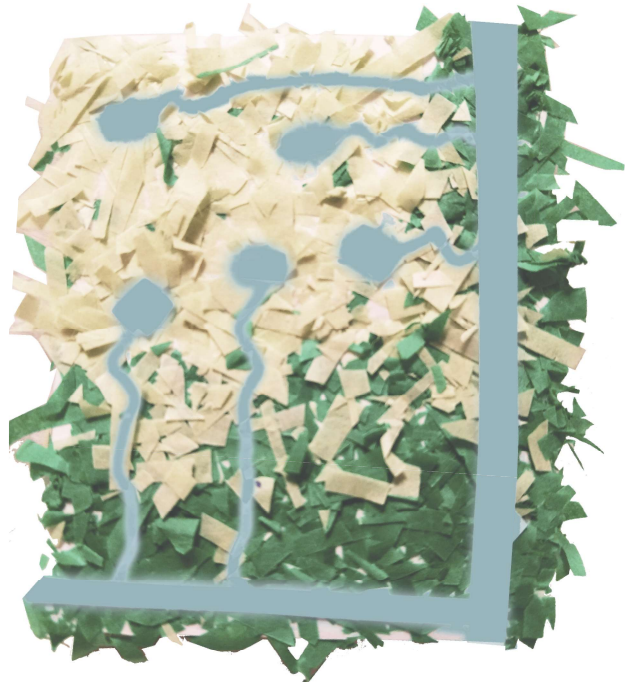
Noe av overvannet fordrøyes inne i hagekolonien, mens overskuddet ledes ut til bekken. (Konseptmodell av revet papir)
