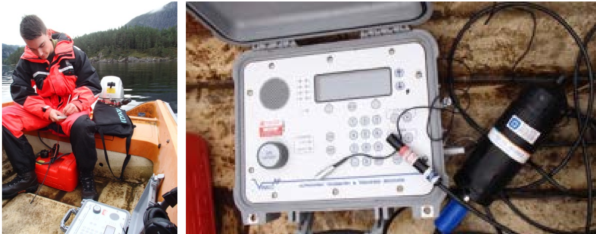
Figur 11. Til venstre: Manuell peiling på Evangervatnet ved masterstudent Espen Åsan, NMBU. Til høgre: Mottakarane VR100 (venstre) og TBR700.
