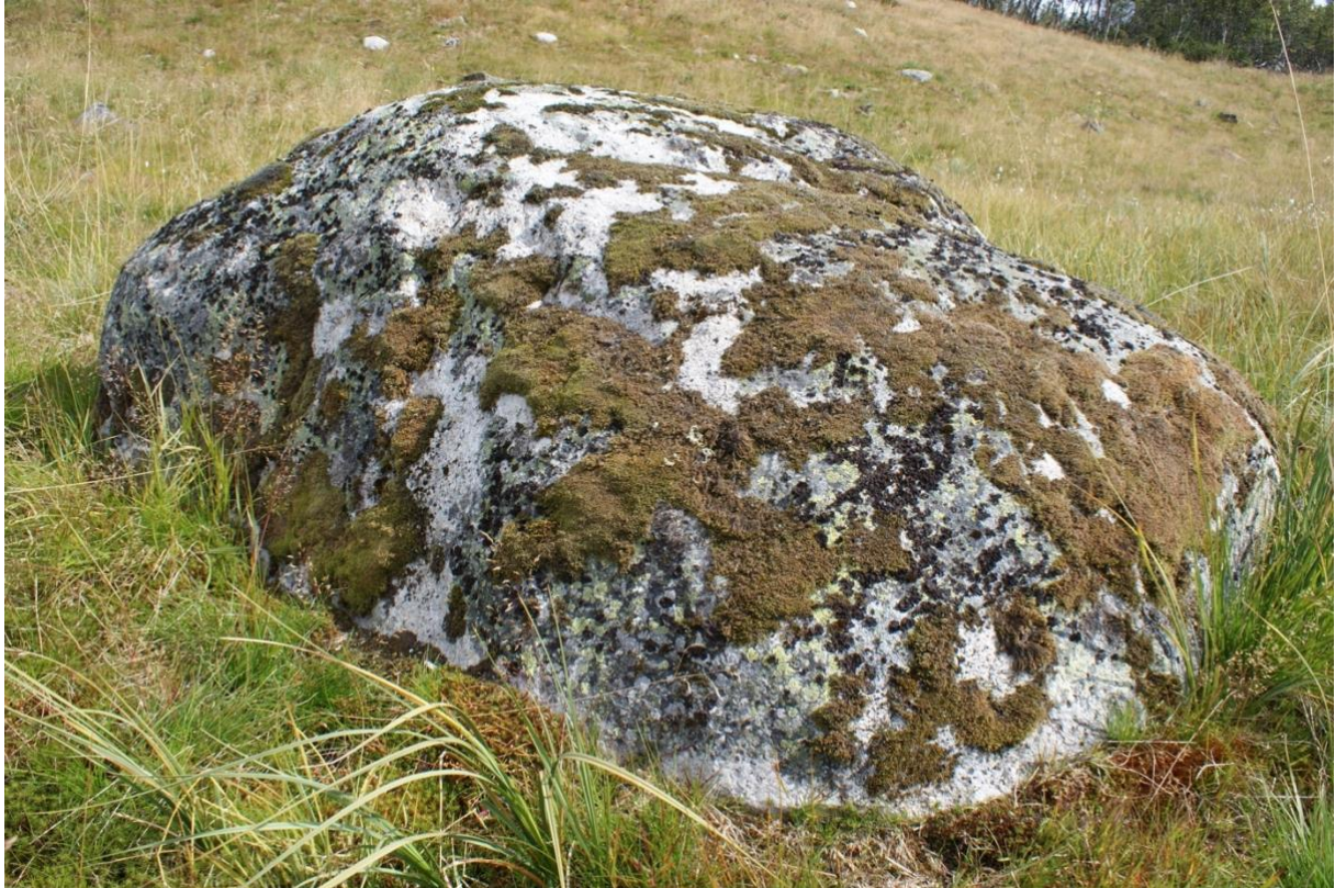
Figur 11: Stein nummer 3 viser lite tegn til jordsynking, og på denne siden av steinen ble det registrert 5 cm jordsynking. Den andre siden målte 11 cm, som gir et gjennomsnitt på 8 cm. Det lyse skillet nederst på steinen indikerer at jorden rundt steinen har sunket noe. Det ble vurdert at 38 % av jorda rundt denne steinen bar preg av å ha sunket.
