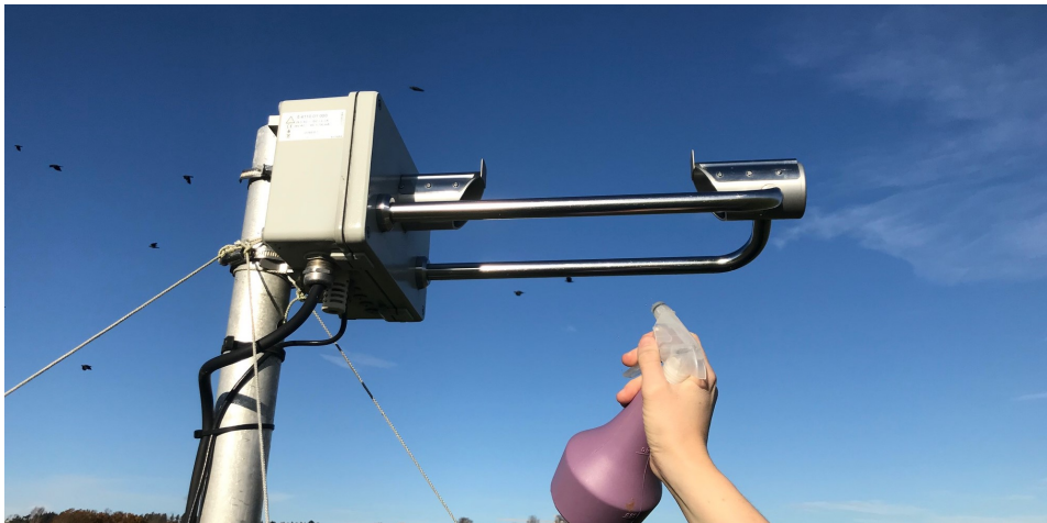
Figur 3.21: Rekonstruksjon av hvordan eksperimentene på Haukeliseter ble utført. På bildet sprayeres det nedenfra. Merk innfallsvinkelen som var nødvendig for at det skulle komme vann ut. Foto: Mareile Wollf
