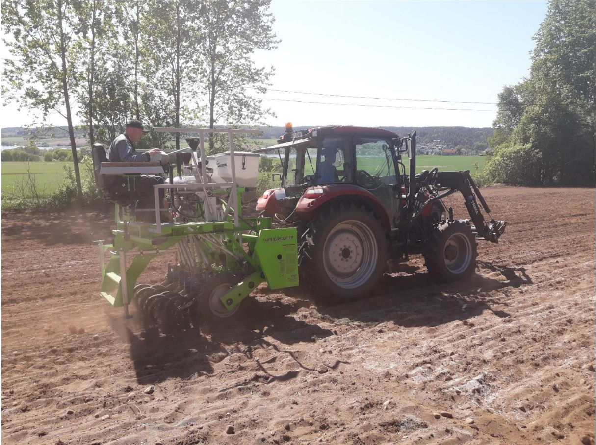
Bilde 12 tatt 18/5-18 viser såing med Wintersteiger forsøkssåmaskin.
