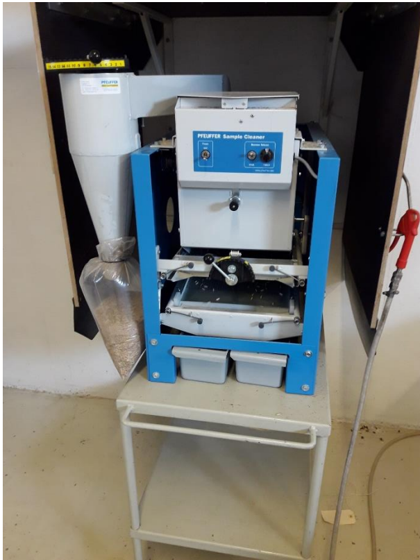
Bilde 17 viser Pfeiffer Sample Cleaner rensesmaskin for kornprøver.
