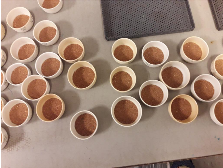
Bilde 21 viser digler med jord etter gløding.
