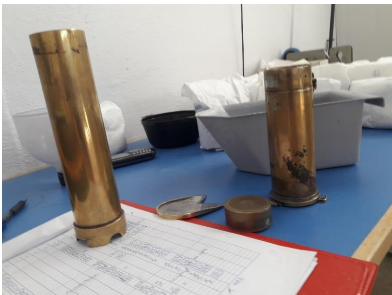
Bilde 18 av delene i det manuelle apparatet for oppmåling av 250 ml korn, f.v. overdel, spjeld, lodd og underdel.
