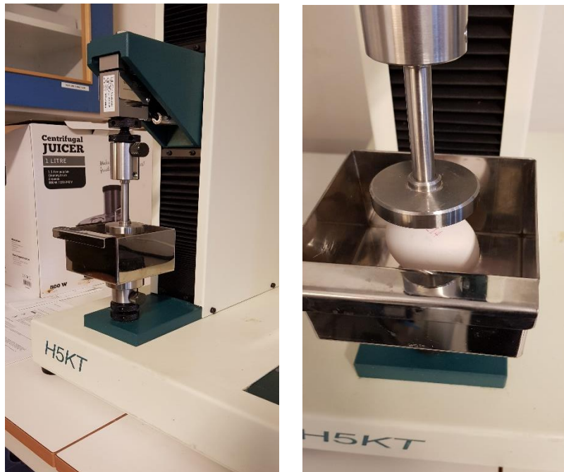
Bilde 3: Knekkstyrketest med Tinius Olsen Texture Analyser HK5T
