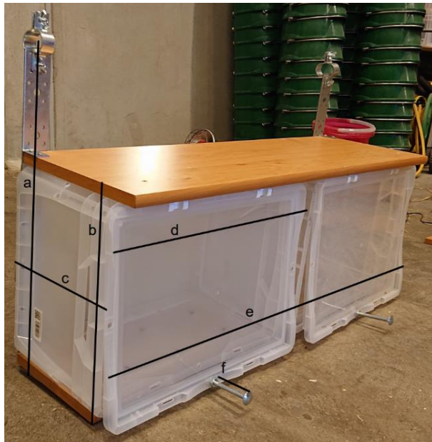
Figur 2.7a Konstruksjonen av plastbokser og treplater brukt under problemløsningstesten. Mål: a) Total høyde fra oppheng til underside: 50 cm. b) Høyde fra øverste hylleplate til underside: 34 cm. c) Total dybde: 26 cm. d) Bredde per boks: 40 cm. e) Total bredde: 83 cm. f) Håndtak, lengde: 7 cm.
