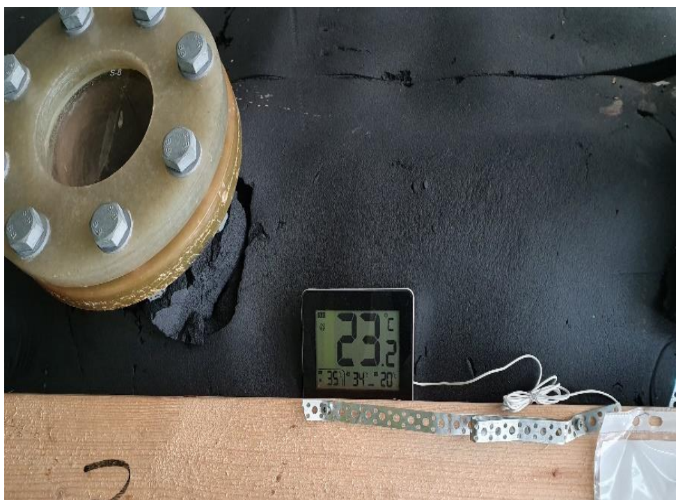
Bilde 3. Sylindriske vindu i reaktorvegg for observasjon og temperaturmåler, som viser temperatur i konteineren utenfor reaktoren
