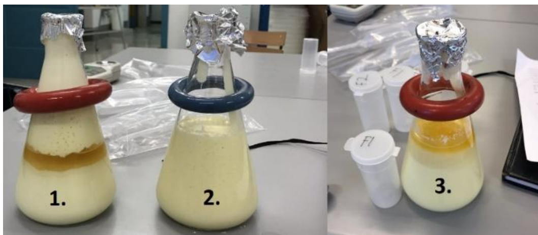
Figur 15. Bilde av sluttkonsentrat i vannbad produksjon 3 (1. Konsentrat med mest røring. 2. Konsentrat uten røring. 3 Konsentrat med halv rørintesitet).
