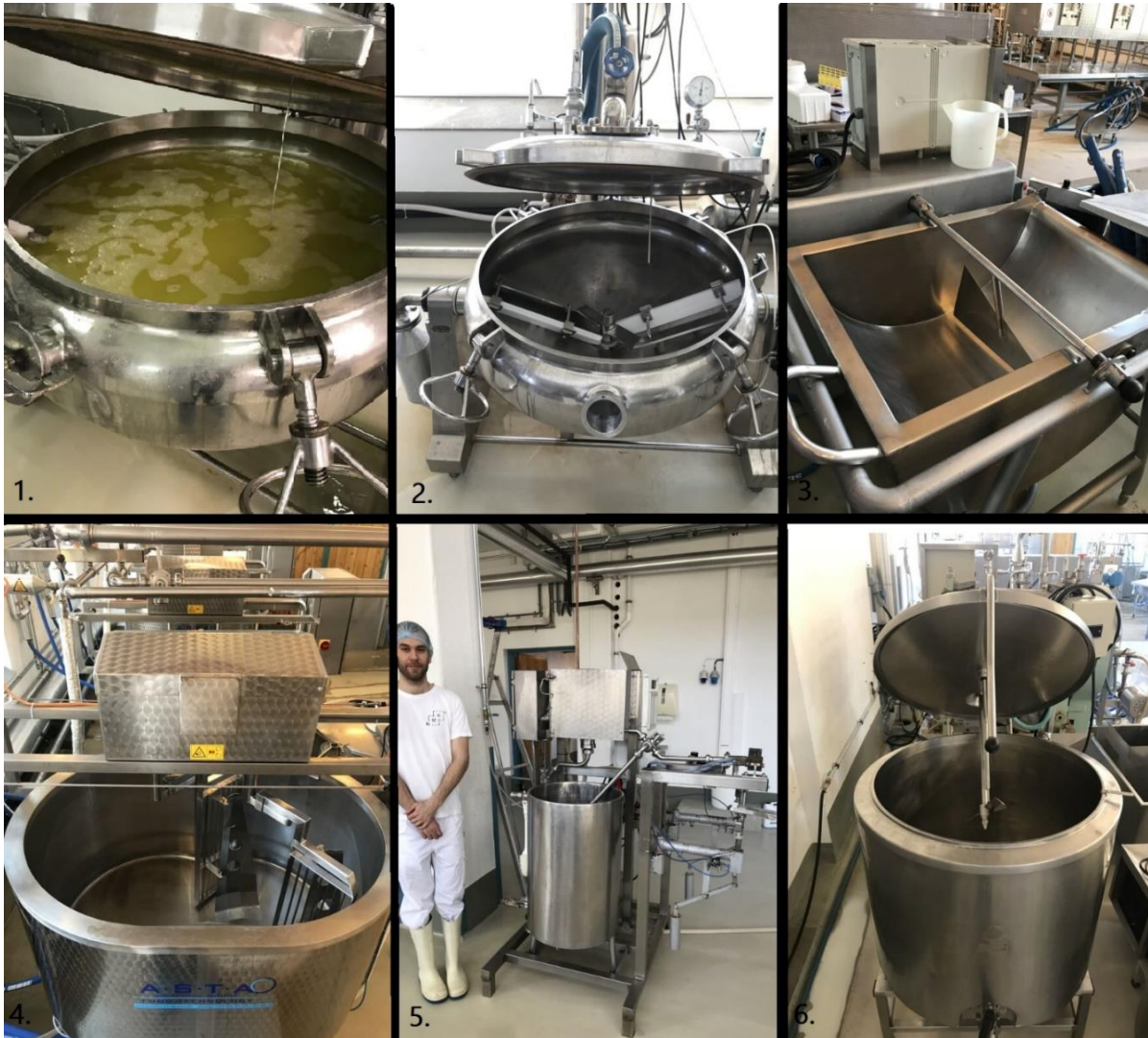
Figur 13. Bilder av material og utstyr til produksjon i hoved forsøk. 1. NF-konsentrat av UF-mysepermeat før forvarming i brunostgryten, 2. brunostgryten, 3. 200 L ystekar, 4. 500 L ystekar, 5. Brunostpakkemaskin sammen med Ola Tjøland (Overingeniør KBM) til venstre for å illustrere størrelsen på utstyret, 6. 300 L kjøletank og røreverk.
