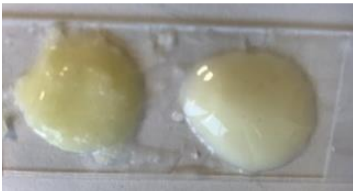
Figur 18. Bilde som viser krystallklumper i konsentrat. Til venstre konsentrat etter inndamping ferdig og til høyre etter flashkjøling i produksjon 3.
