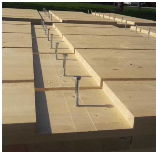
Figur 52: Bilde av skjærspor med skruer på de to samvirkeelementene.
