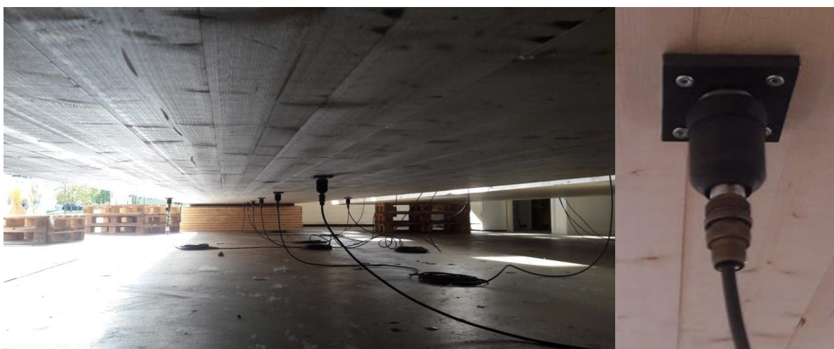
Figur 71: Bilde av akselerometerne festet på elementets underside.
