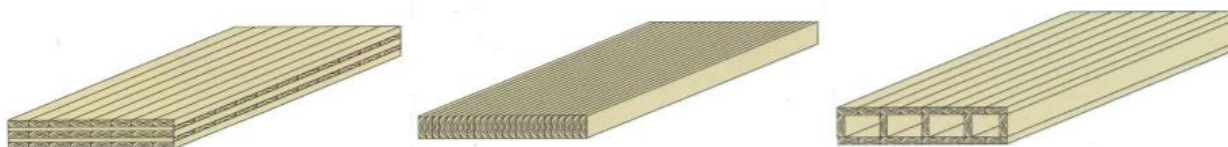
Figur 6: Illustrasjon av krysslagte elementer (venstre), kantstilte elementer (midten) og hulromselementer (høyre) (Treteknisk, 2006a).
