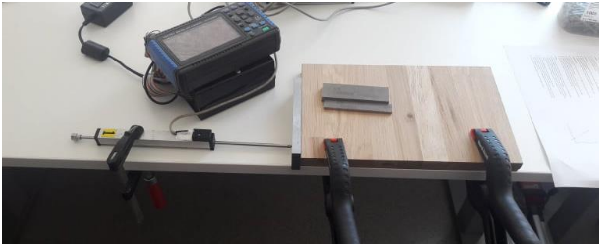
Figur 60: Bilde av kalibrering av sensor 1 til nedbøyningstest. Metallskivene er målestykkene som ble brukt.
