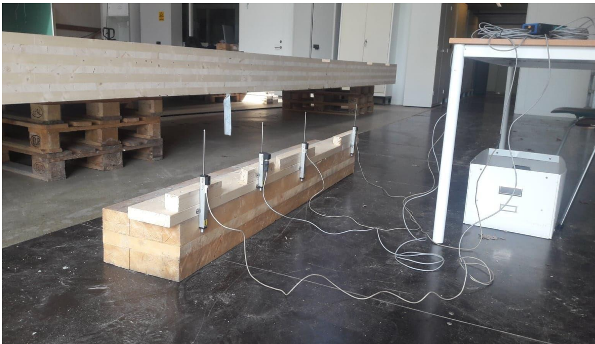
Figur 62: Rigg med nedbøyningsmålere brukt i alle nedbøyingstester.
