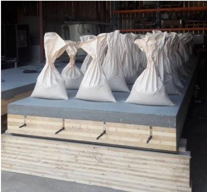
Figur 67: Bilde av nedbøyningstest med jevnt fordelt last utført på et samvirkeelement.
