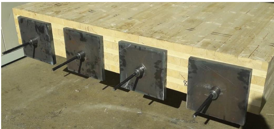
Figur 56: Bilde av stålplatene på et av 7-lags elementene etter forspenning.
