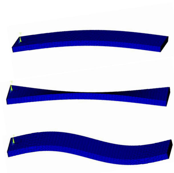
Figur 72: De tre første svingeformene tilhørende de tre første egenfrekvensene. 1 svingeform øverst, 3. svingeform nederst.
