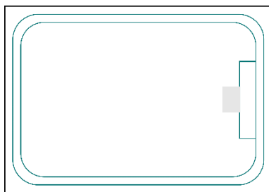
Figur 4.16: På innsiden av et kontaktløst smartkort er det en sekundærspole det induseres en strøm i, som videre gir energi til en mikrochip hvor informasjonen ligger.
