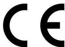
Figur 3.3: CE-merking kan gis til elektriske produkter, og betyr at produktet tilfredsstillende alle minstekrav innen HMS som er definert av EØS-avtalens synkronisering av norske og europeiske myndigheter (43).
