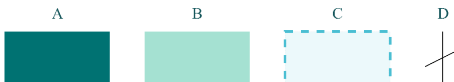
Figur 7.2: Betydningen av de grafiske elementene som blir brukt i funksjonsanalysen. A indikerer at det er snakk om funksjon, B indikerer at det er snakk om et løsningsmiddel, C angir fokusområdet for oppgaven og D indikerer at analysen fortsetter til/fra et annet sted i analysen.
