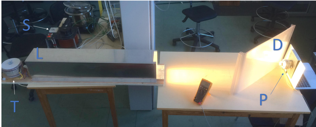
Figur 3.2: Figuren viser et bilde av laboppsettet brukt for å måle transmittans. På bilde vises lysboksen (L), strømforsyneren (S), transformatoren (T), dekkglasset (D), pyranometeret (P) og multimeteret (står midt på bordet). Dette samsvarer med tegningen i figur 3.1.
