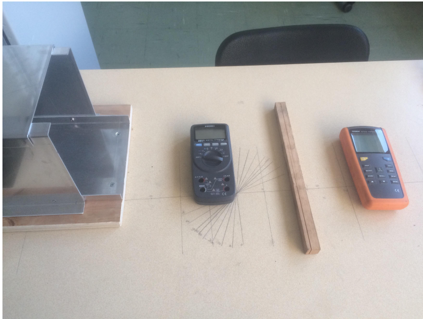
Figur 3.7: Figuren viser hvordan gjenstander ble plassert på bordet mellom lysboksåpningen og pyranometeret for å lage hindringer for den reflekterte strålingen fra bordoverflaten.
