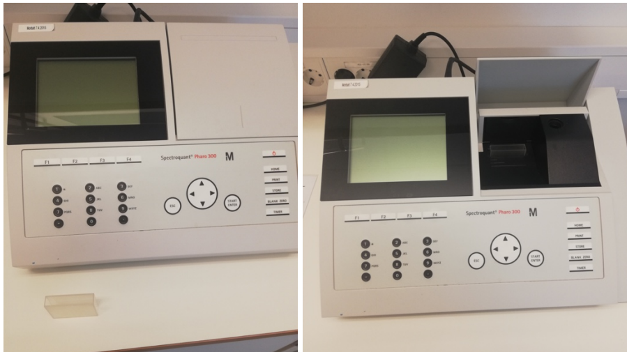
Figur B - 2 Spektrofotometer for måling av farge med kyvette.
