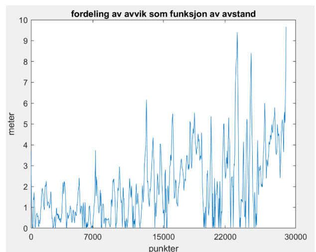
Figur 36: fordeling av avvik. Data samlet med mobiltelefon 17.02, uten estimering. Horisontalaksen viser punktnummer fra start og vertikalaksen viser meter.
