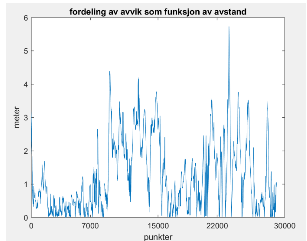
Figur 86: fordeling av avvik. Data er fra alle datakilder uten CPOS og tur og friluftsruter base med referansedata fra mobiltelefon 17.02, o-kart har st avvik på 10 m, estimert. Horisontalaksen viser punktnummer fra start og vertikalaksen viser meter.
