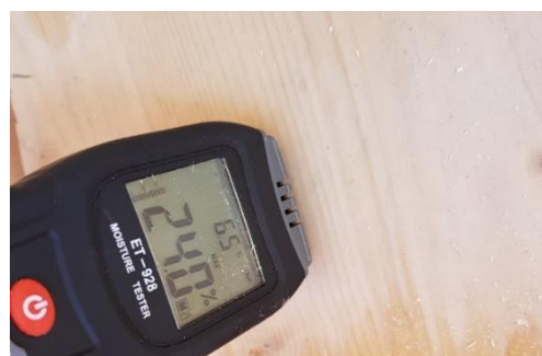
Figur 17 Måling med trefuktmålar
