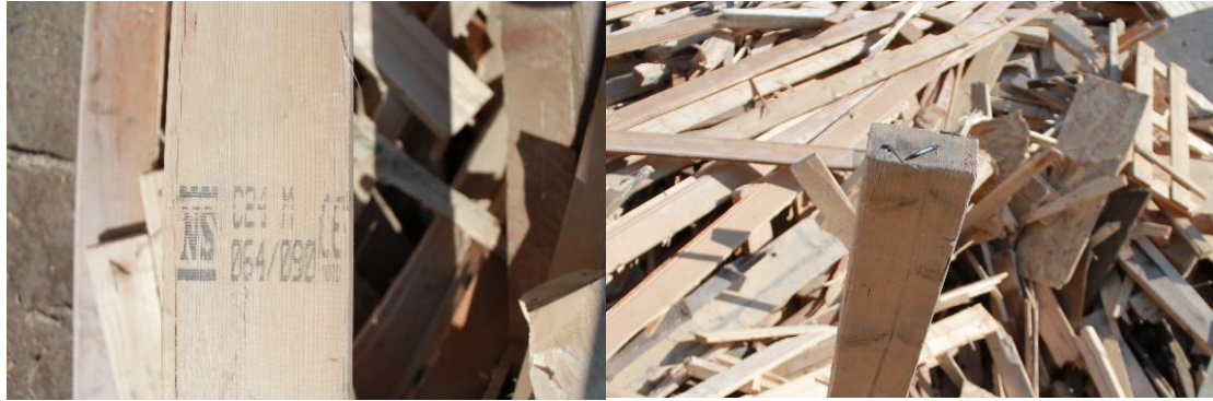
Figur 8. til venstre, en brukt lamell av C24. Til høyre, metallrester i trelast er en utfordring.
