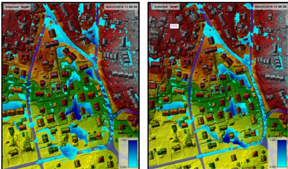
Figur 4.16: Simulert takfall overflateavrenning ved kl. 13:00 og kl. 14:00(Skjermdump-HEC-RAS)
