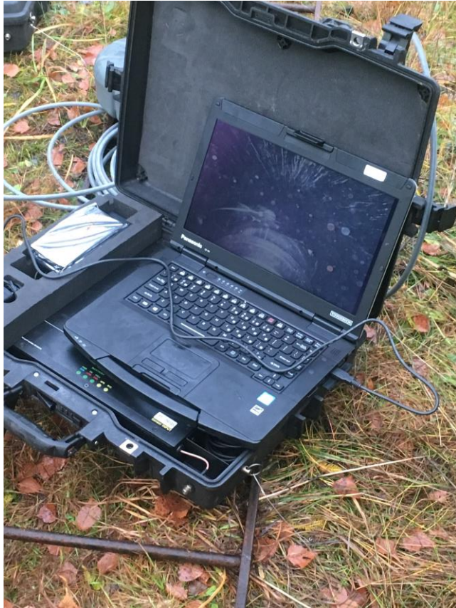
Figur 16: En datamaskin viser filmen fra inne i røret
