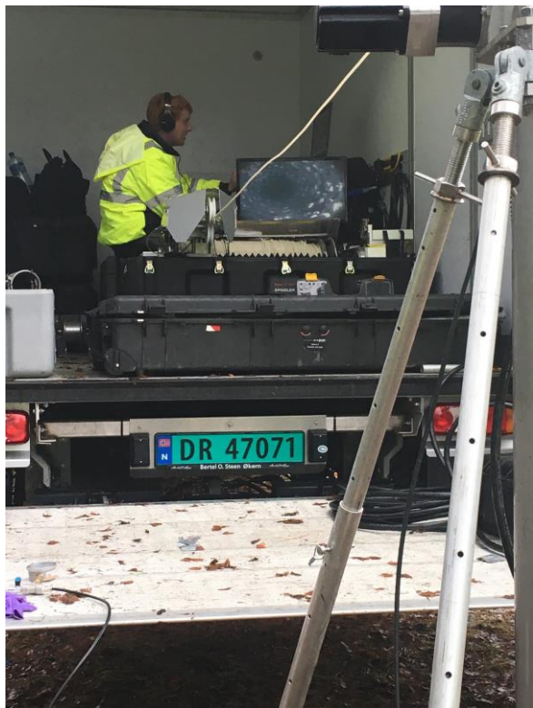
Figur 22: Operatør fra Xylem følger med på lyd og data fra Sahara under inspeksjon. Videoen fra Sahra kan sees på skjermen foran operatøren. Kilde: Helene Olsbye
