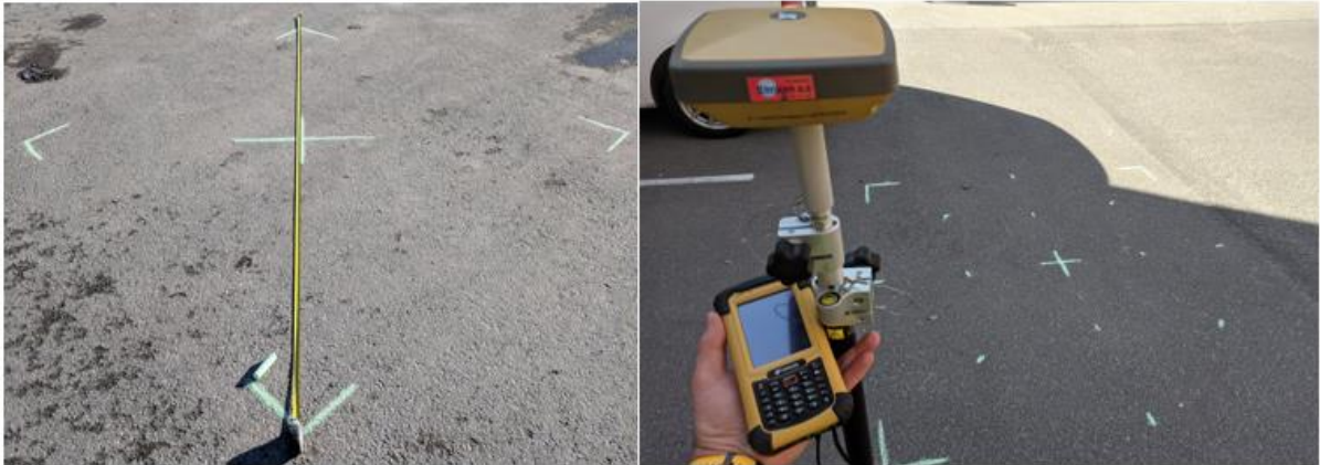
Figur 18: Flatene ble målt med målebånd og tegnet ned med kritt
