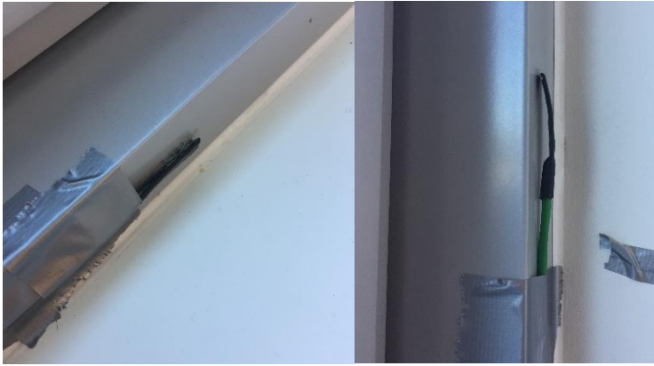
Figur 20 Innvendig termoelementer har nesten løsnet på henholdsvis bunn- og sidefasadeelement på Sørhellinga.
