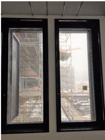
Figur 13 Bilde av vinduene som ble brukt under målingen. Termoelementene ble festet på det høyre vinduet, mens ledninger til utvendige termoelementer ble ført gjennom det venstre vinduet.
