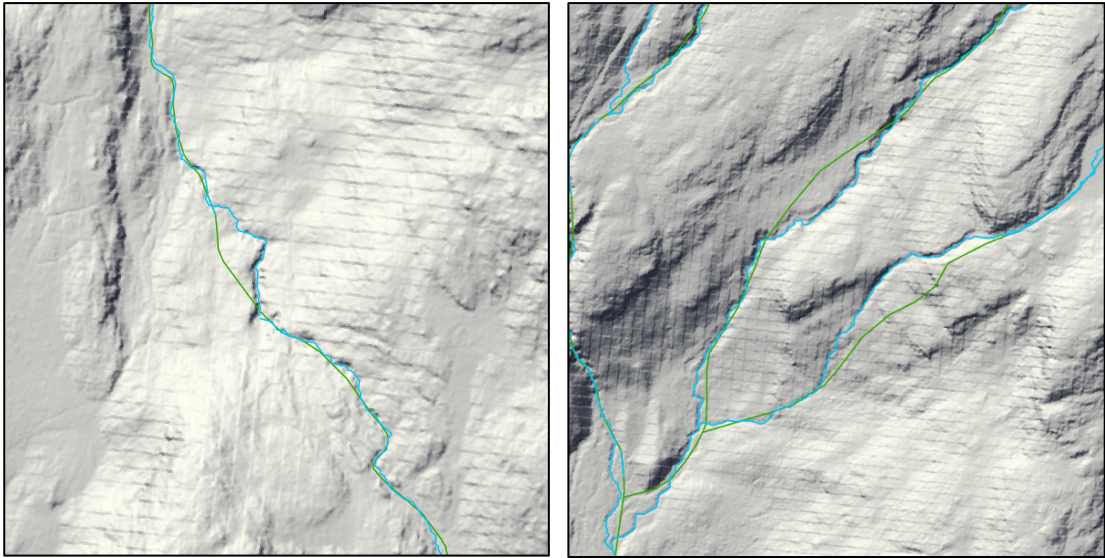
Figur 40 Eksempel på situasjoner hvor informasjon er overført fra original FKB-linje (grønn) til ny linje med det modellerte datasettets geometri (blå)
