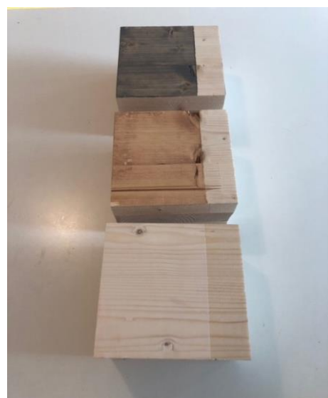
Figur 5: Tre av de fem massivtrebitene, ferdig overflatebehandlet
