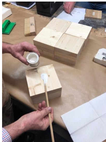
Figur 6: Påfører overflatebehandling på den første overflaten
