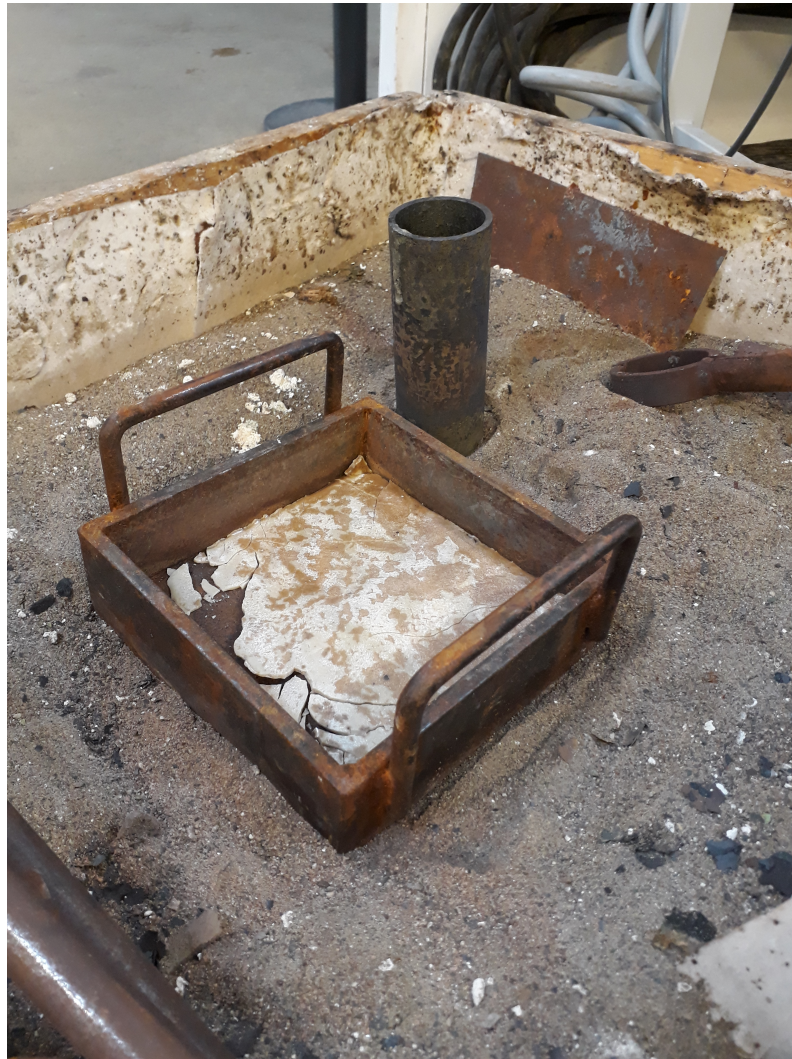
Figur 3.4: Bilde av størknet salt som har blitt tømt ut etter forsøk. Her: \text{SrO-CaCl}_2\text{-NaCl} . Bildet viser nikkeldigelen (sylinderformet) som brukes i forsøk og beholderen (firkantet) hvor smeltet saltblanding tømmes ut etter bruk. Dette står i en sandkasse for å beskytte underlaget mot varme og fange opp eventuelt søl av smeltet salt under tømming.
