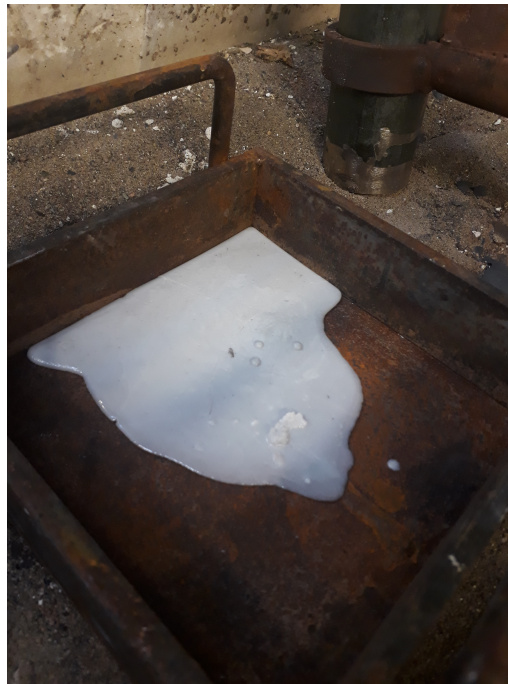
Figur 4.4: MgO-ZnCl 2 -NaCl-KCl, tømt ut etter forsøk. Klumpene er sannsynligvis MgO som ikke har blitt løst i saltet, og kan være forklaringen på den lave absorpsjonen i forsøk 2.
