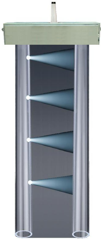
Figur 3.1 Illustrasjon av hvordan løsningen er tenkt seende ut. På toppen sitter en boks som sender dataen via GPRS til internett.
