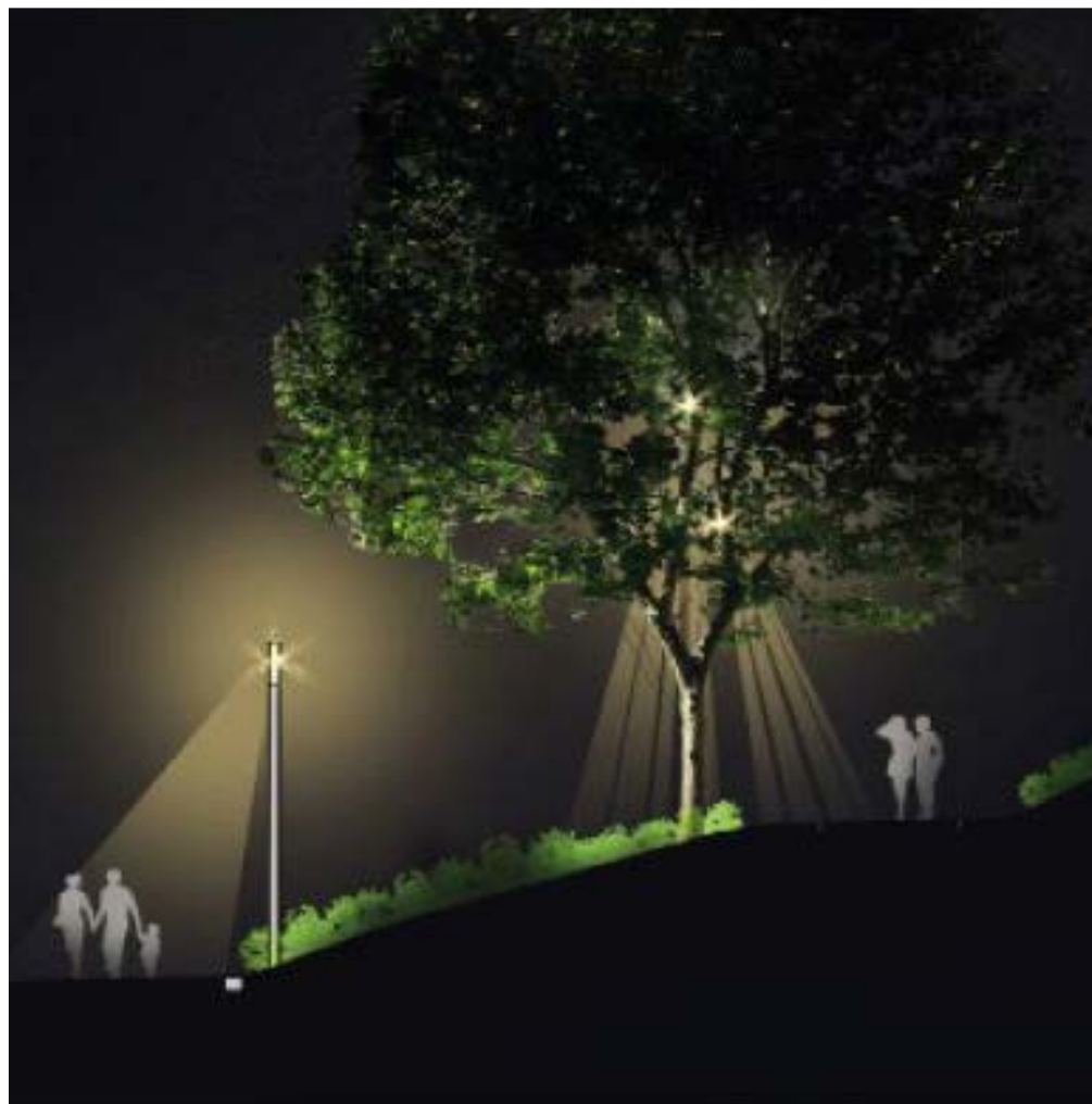
FIGUR 232: Illustrasjon av tenkt belysning og ulike masthøyder i Klosterenga park (COWI., et al. 2018)
