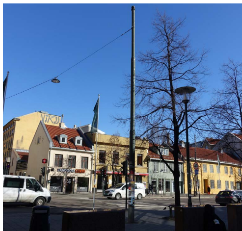
Overgangen fra strøkgate med vaierstrekk, til Grønland torg med lavere mastmonterte armaturer.
