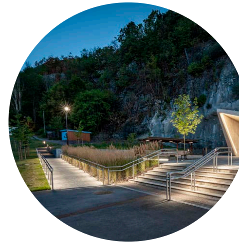
FIGUR 112: God grunnbelysning supplert med utheving av bevegelseslinjer, her ved innfelt belysning i håndløpere langs bevegelseslinjene, gir økt trygghet (s.n, u.å)
