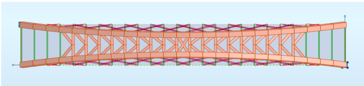
Figur 8-6: Avstivning mellom to øverste buer
