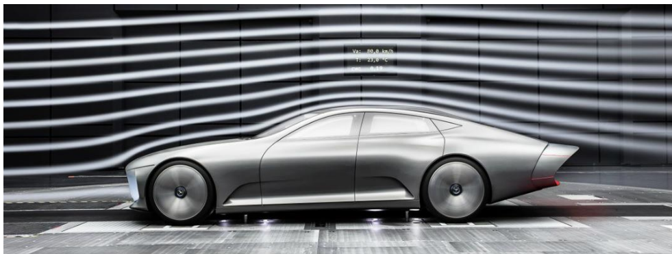
Figur 4.6: Mercedes-Benz Concept IAA, med en svært lav drag-coefficient på 0,19. Strøm-linjene viser hvordan det kreves arbeid for å flytte luften rundt eller over kjøretøyet når det er i fart [74].
