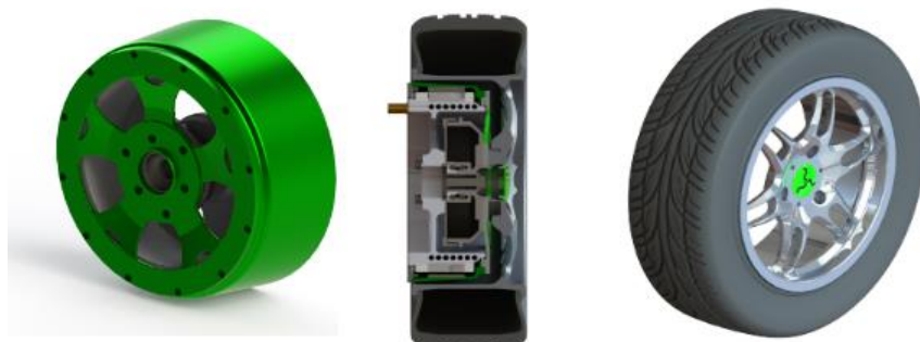
Figur 5.9: Illustrasjon av hvordan Elaphes "in-wheel"-motorer er spesiallaget for å passe inne i tradisjonelle felger. Modellen som er vist er ikke S400 [84].
