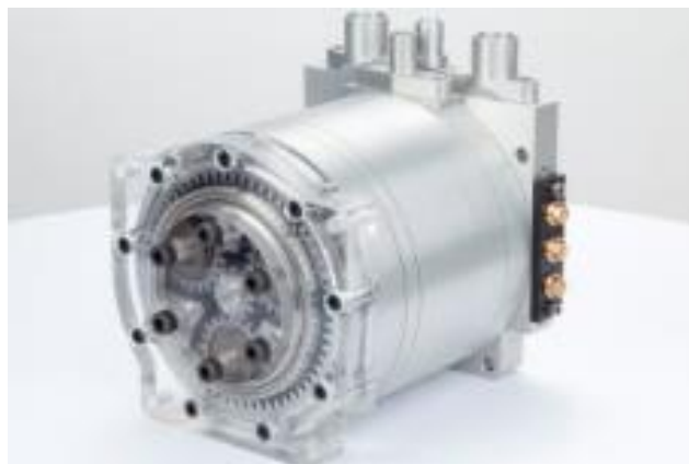
Figur 5.6: Equipmake APM 120, med innsyn til planetgirkassen [81].
