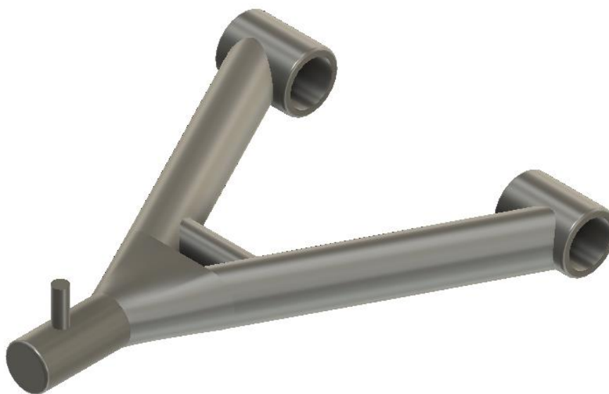
Figur 10.18: Forslag til design av nedre bæream, etter dimensjoneringsarb eid. Tappen som stikker opp av elementet helt til venstre er ikke utredet, og er kun med av illustrative årsaker.
