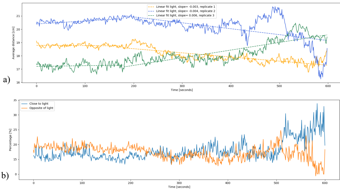
Figur 11: Data fra deteksjonsforsøk med Blue, OD5, P 3 . Lysstimulus skrudd på etter 180 sekunder. a) Gjennomsnittlig avstand til lyskilden, med lineære regresjonslinjer for alle tre replikat. X-aksen viser tid (sekunder), mens Y-aksen viser gjennomsnittlig avstanden fra lyskilden. b) Prosent-andel av kopepodittene i de ytterste seksjonene (å 8cm / 20%) av akvariet. X-aksen viser tid (sekunder) og Y-aksen viser prosent-andelen av kopepodittene i seksjonene nærmest og lengst fra lysstimulus.. Figurene er utarbeidet av Live Forfang Bjørnstad og Maria A. Solstad, gjengitt med tillatelse.
