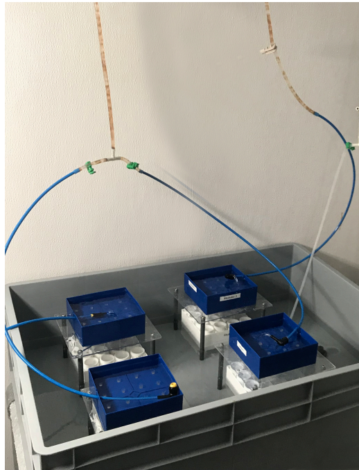
Figur 2: Lakselusklekkeri på NTNU Sealab – fire klekkestasjoner med 4x4 klekkeinkubatorer med tilførsel av filtrert sjøvann
