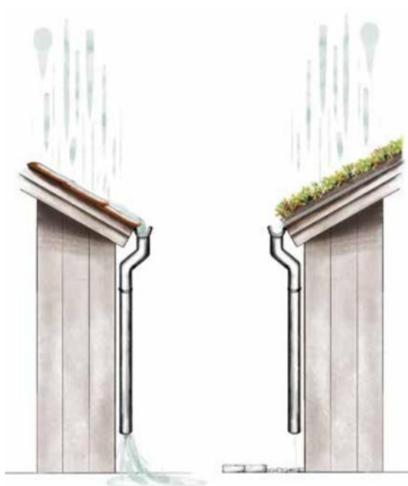
Figur 5: Illustrasjon av avrenning fra svart tak (til venstre) versus grønt tak (til høyre) (Bergknapp, 2018)
