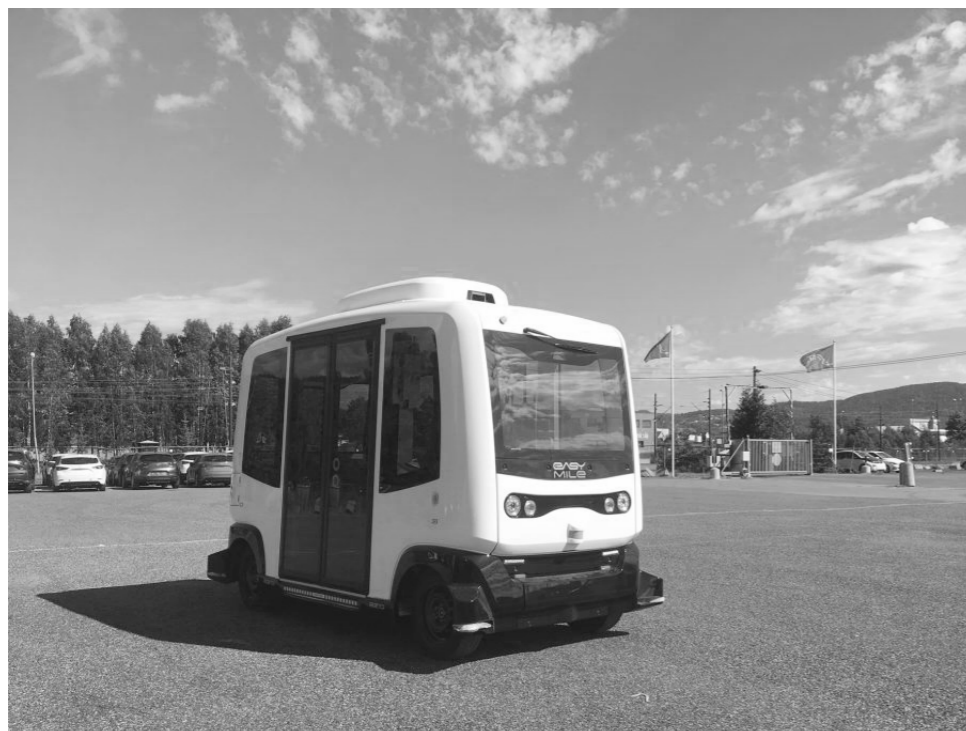
Fig. 8. Autonom buss til uttesting i Kongsberg i forbindelse med testarena Kongsberg. Bussen er utstyrt med knapp for å betjene rullestolrampe. Den selvkjørende bussen er produsert av selskapet Easy Mile. (Brakar AS, 2018)
