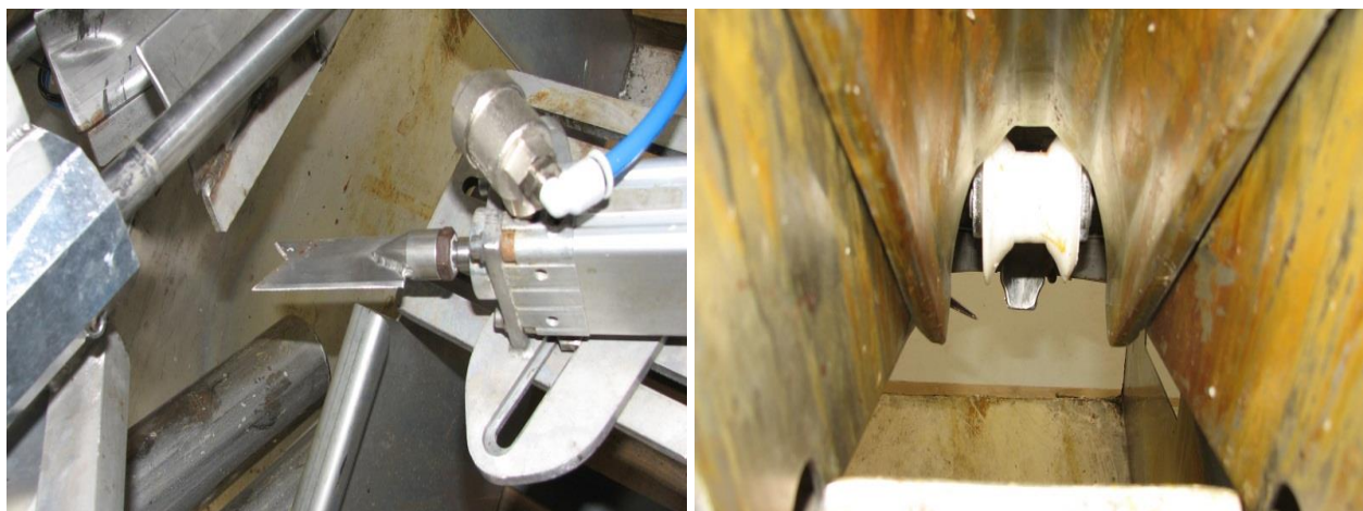
Figur 5 – SeaSide AS sin pneumatisk drevne slag/bløggemaskin for automatisk bedøving og bløgging. Kniv vist i venstre bilde. Stikking skjer etter at en fisk i gangen blir fiksert i maskinen (høyre bilde).
